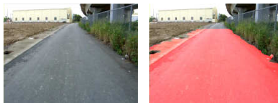
(a) (b) 圖一、利用正規化的 R、G、B 所選取出的候選區域。(a)為原始圖，(b)為選出候選區域的結果圖。
