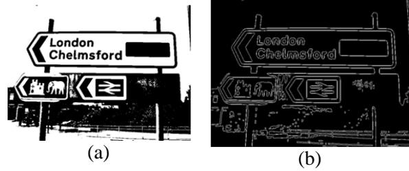
圖 3 Canny 邊緣偵測(a)二值化影像 (b)邊緣偵測後
