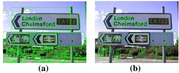
圖 5(a)連通元件標記結果(b)前置過濾結果
