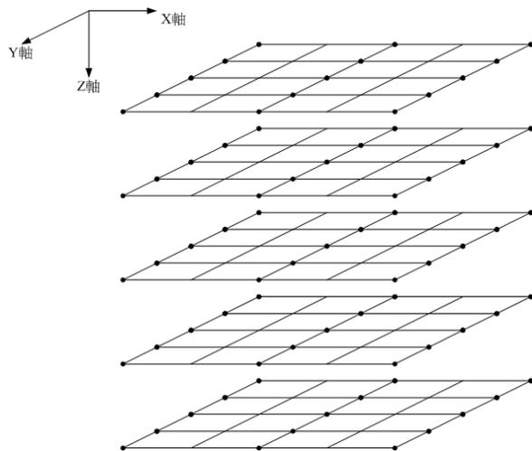
圖 7 校正點(3×5×5)取點示意圖
