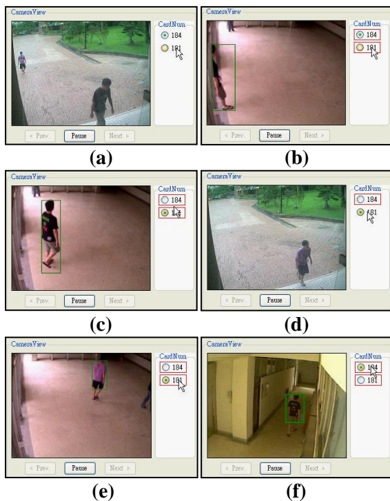
圖 13：兩位配戴 Tag 人員前後通過出入口的追蹤範例(a)通過前(b)(c)不同 Tag 對應到相同的人員(d)透過訊號衰減檢測機制排除(e)(f)點選不同 Tag 顯示對應人員的所在位置
