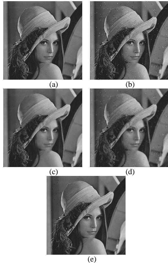
圖 6. 低胡椒鹽雜訊視覺比較 (a)原始影像 (b)0.006 雜訊影像 (c)中值濾波影像(d)均值濾波影像(e)本研究方法之影像
