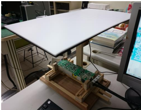
圖 13 遮光板架設方式
