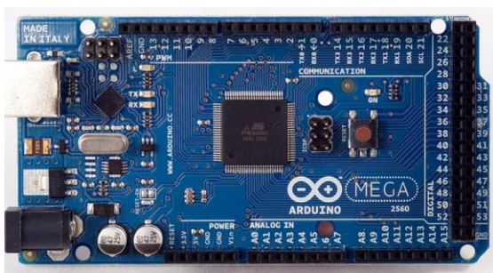
圖 3.2 Arduino MEGA 2560 R3
